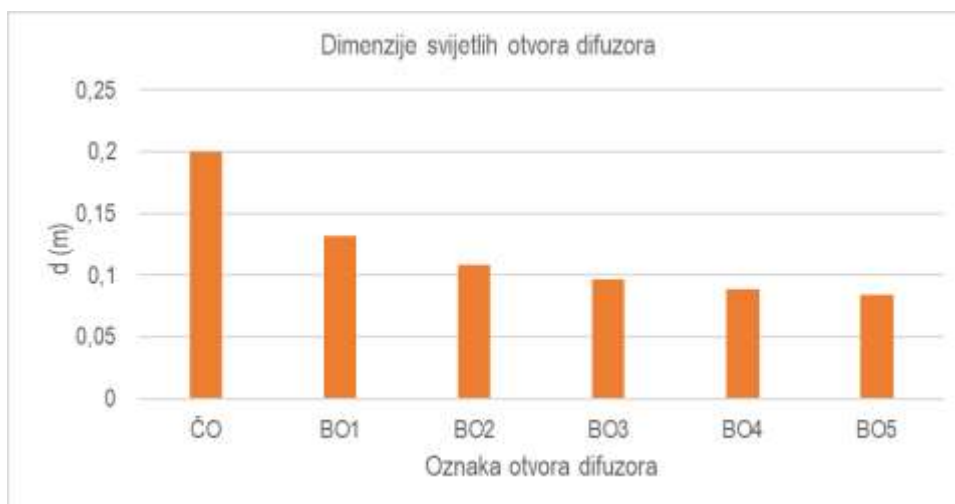
Slika C.4. Svijetle dimenzije čeonog i bočnih otvora difuzorske sekcije
