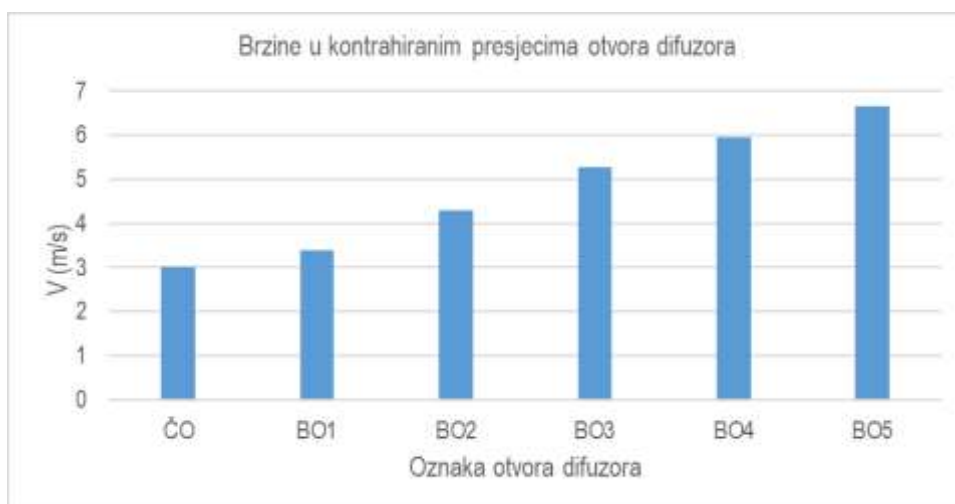
Slika C.3. Brzine istjecanja na kontrahiranim presjecima otvora difuzorske sekcije
