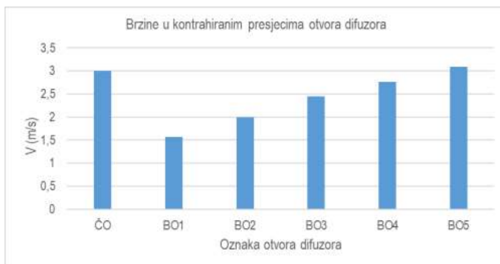
Slika C.15. Brzine istjecanja na kontrahiranim presjecima otvora difuzorske sekcije
