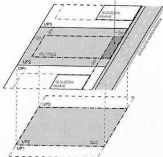
Podzemna građevinska linija (GI 0) predstavlja liniju do koje je moguće graditi podzemne djelove objekta (podzemne etaže). Iste mogu zauzimati veću površinu od gabarita objekta u nivou prizemlja, odnosno podzemna građevinska linija ka javnoj površini može se naći na regulacionoj liniji (ili u izuzetnim slučajevima prolaziti ispod infrastrukturnih objekata koje čine javne površine (ulice, trgovi, parkovske površine....), spajajući lokacije u jednu jedinicu građevinskog zemljišta.
