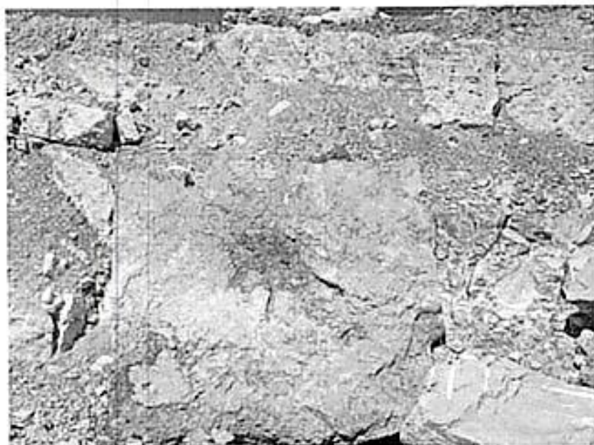
Slika 3: Raspadnuti krečnjaci sa zemljum i humusom u površinskom dijelu ležišta i bituminozni materijal u blokovima krečnjaka sivo crne boje
