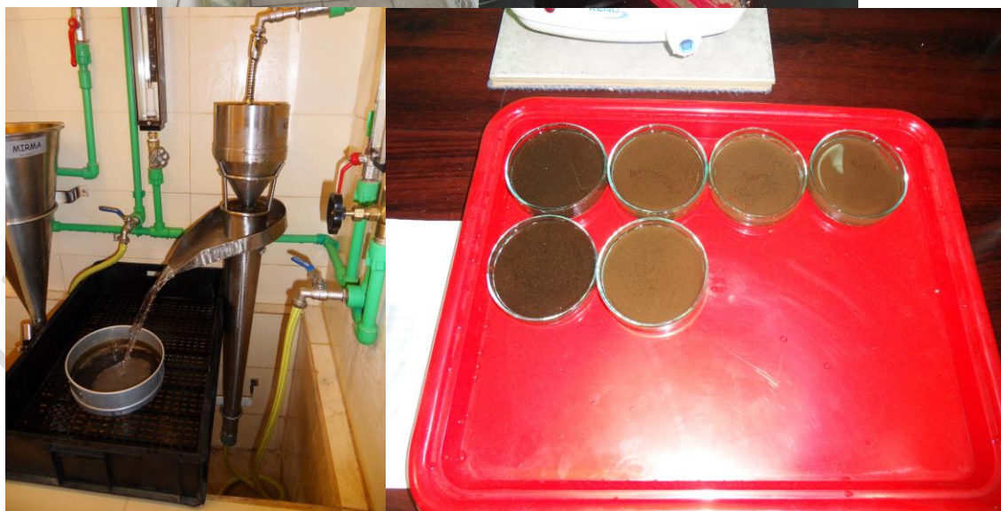
Sl. 03-06.: Procesuiranje uzoraka KCN u laboratoriji. Slike 03 i 04 sušenje uzoraka; 05 elutriator Kort's-ovog tipa sa sitom u toku rada i 06 zemljište uhvaćeno na sitima koje se provjerava na prisustvo KCN
