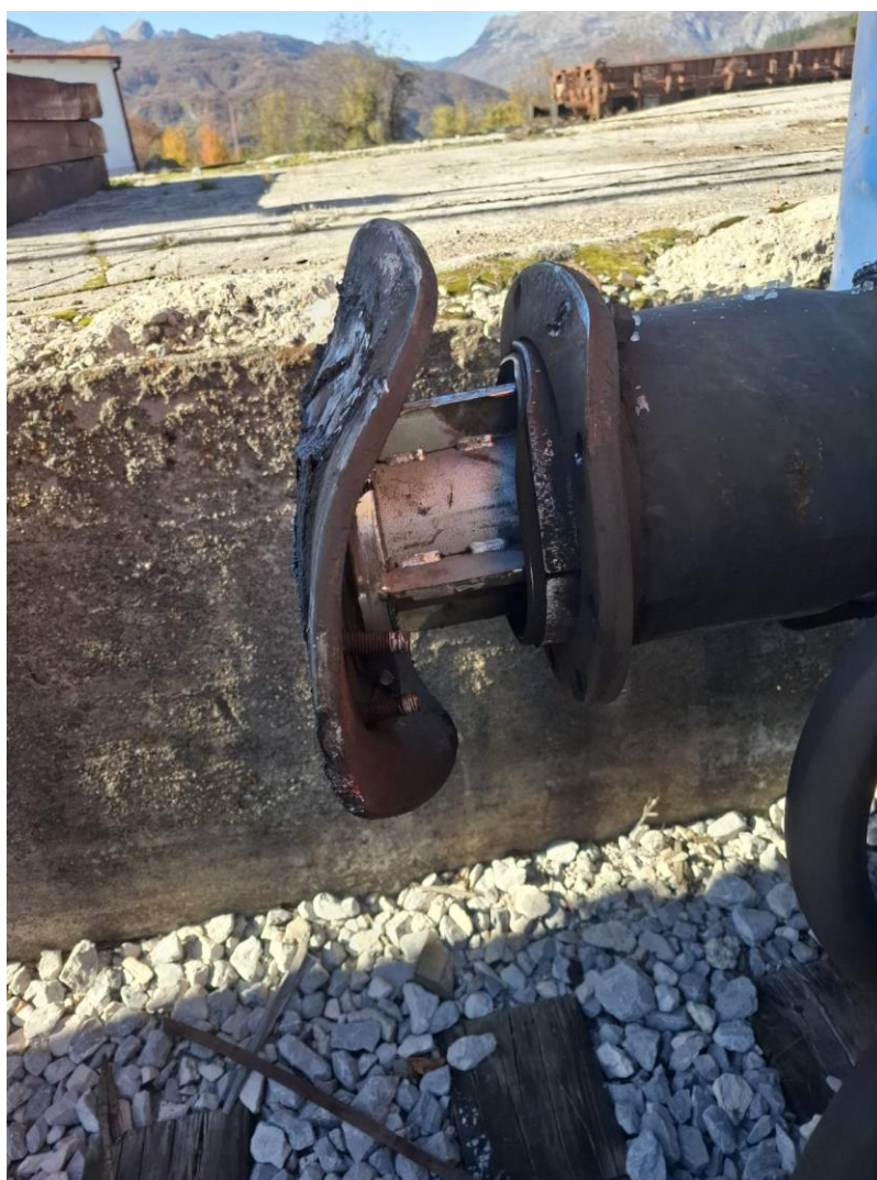
Slika 5. Oštećeni odbojnik na lok 461-038
