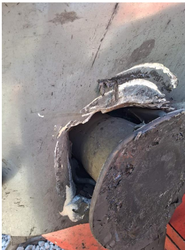
Slika 6. Oštećeni odbojnik na lok 461-043
