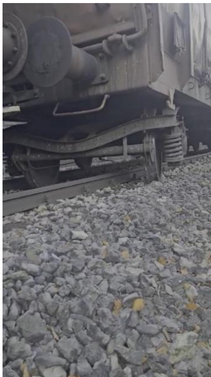
Slika 16. Iskliznula prva osovina u obrtnom postolju na kolima br. 31 72 5956 520-6
