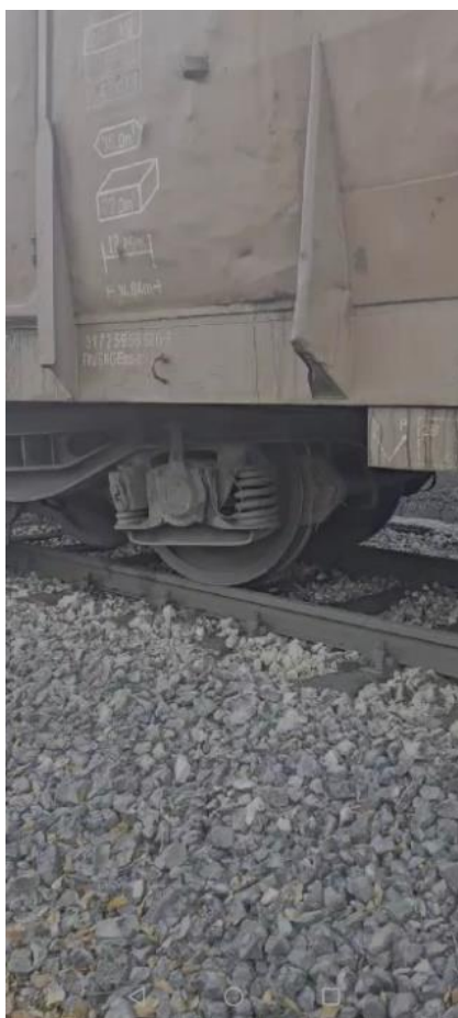
Slika 17. Druga osovina u obrtnom postolju od kola br. 31 72 5956 520-6 ostala na kolosjeku
