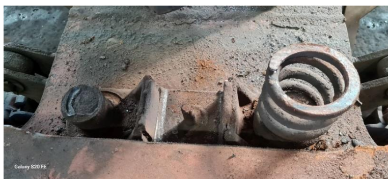
Slika 14. Oštećen bočni klizač na kolima br. 31 62 5952 358-7
