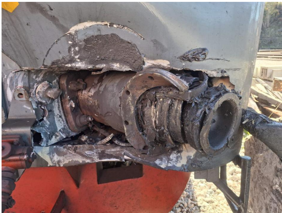
Slika 4. Oštećenje odbojnika i grudne grede na lokomotivi 461-043
