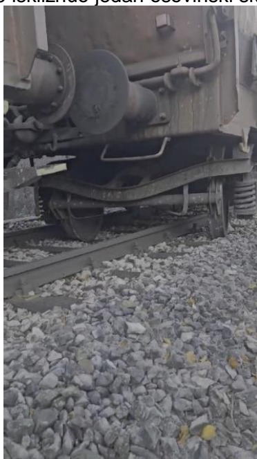
Slika 15. Iskliznula prva osovina u obrtnom postolju na kolima br. 31 72 5956 520-6
