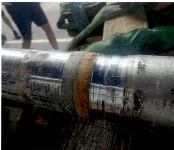
oštećenja na osovini
