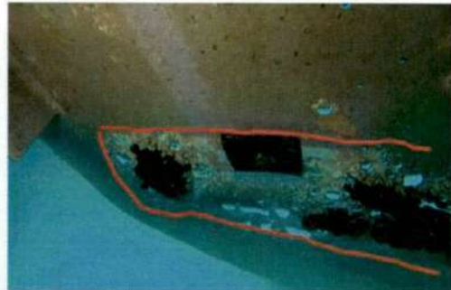
Slika 7. Zona obradila štitnikama, dio na koji se trup oslanja prilikom dokovanja lijevi trup unutrašnja strana
