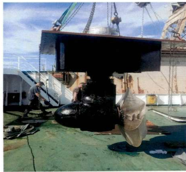
propulzori poslije remonta
