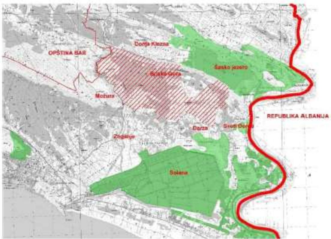
Planom nisu definisane pozicije objekata solarne elektrane Briska gora, već će se izgradnja sprovoditi u okviru zone za izgradnju, na lokacijama koje će biti definisane na osnovu daljih analiza. Solarne elektrane će se graditi na lokacijama na kojima je obezbijeđena saobraćajna pristupačnost i priključci na mrežu elektroenergetske i druge tehničke infrastrukture.
