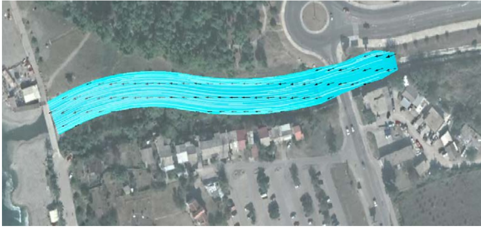
Slika 4 – Situacioni prikaz planve površine u planiranom koritu pri maksimalnom proticaju povratnog perioda 1/100 godina
