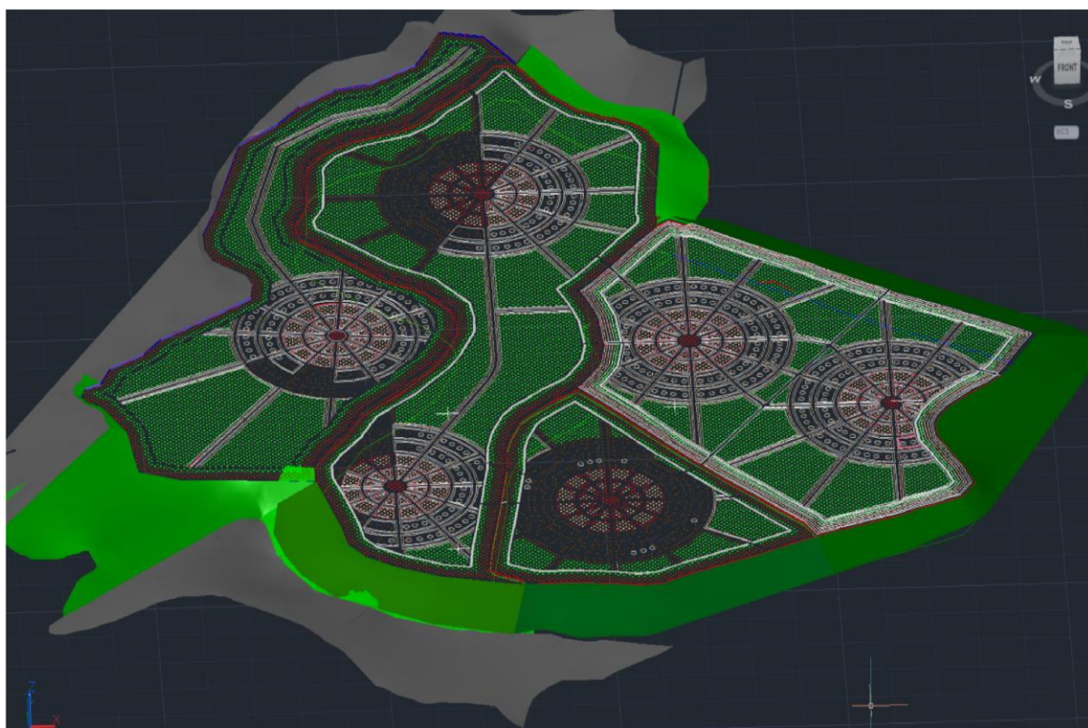
Slika 35. Izgled terena sa zapunjenom depresijom i potpunim uklapanjem bivše deponije sa prirodnim terenom
