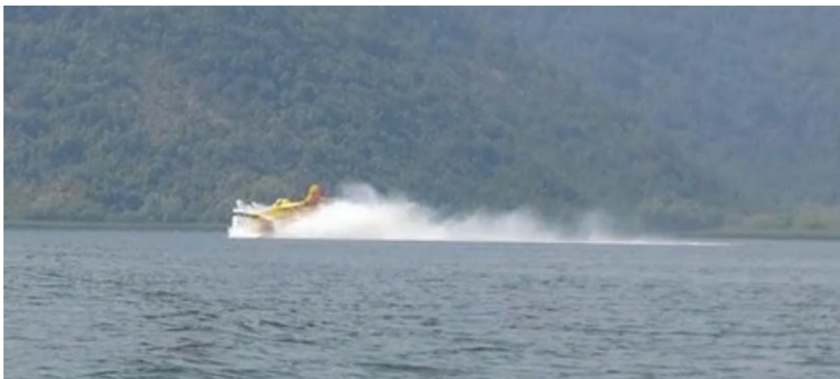
Slika 2. Reakcija aviona nakon kontakta točkova sa vodom
