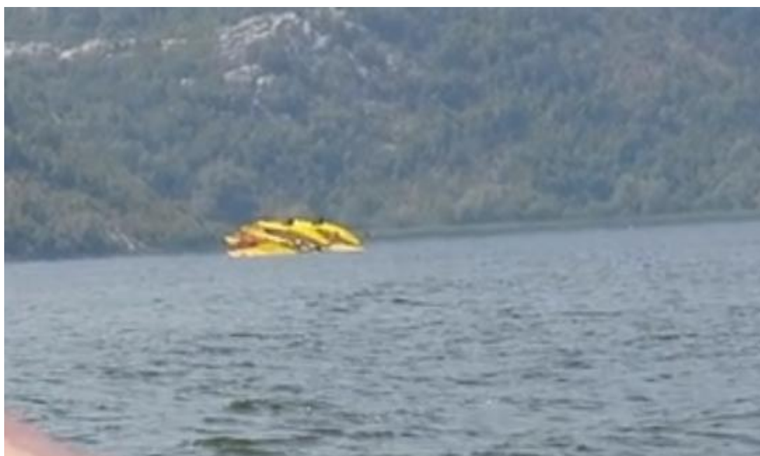
Slika 4. Vazduhoplov ostaje da pluta na površini vode u položaju "na leđa"
