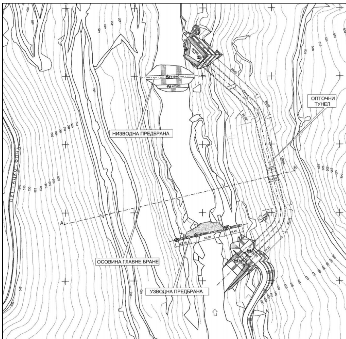
Слика бр. 37 Евакуација воде током грађења
