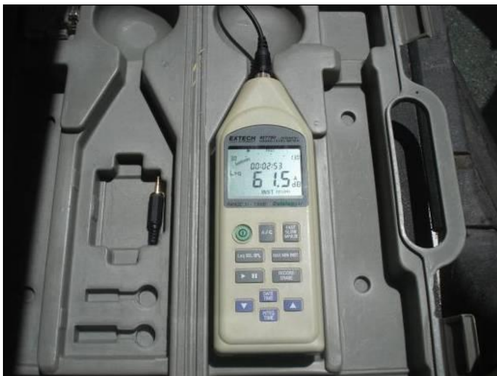
Слика бр. 26 Букомјер - Integrating sound level datalogger, Model 407780, EXTECH
