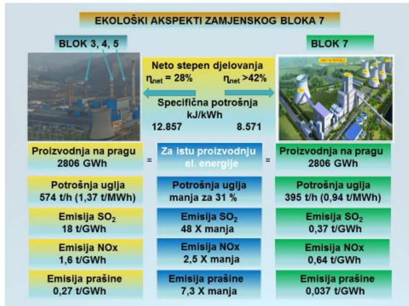
Slika 4. Uporedni prikaz karakteristika postojećih blokova i zamjenskog Bloka 7
