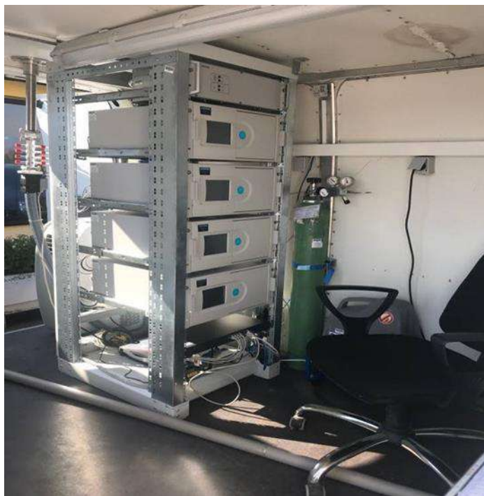
Слика 33. Анализатори SO_2 , NO/NO_2/NO_x , CO , O_3 HORIBA JAPAN
