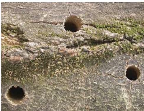
izlazni otvori – pravilni, kružni, 10 mm prečnika, u gornjem dijelu debla
