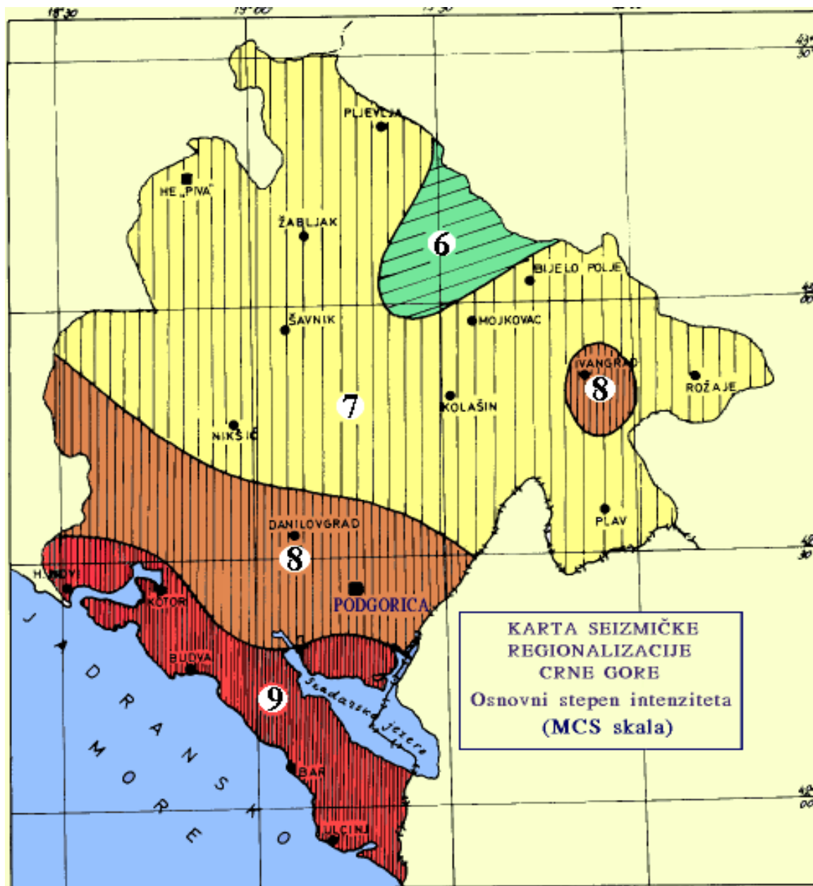
Seizmička rejonizacija Crne Gore (V.Radulović, B. Glavatović, M. Arsovski i V. Mihailov,1982)
