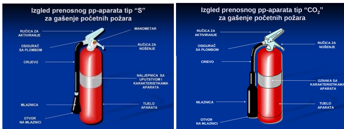
Slika 3. Izgled ručnog prenosnog aparata za početo gašenje požara, tip S-9A i CO 2 -5 kg
