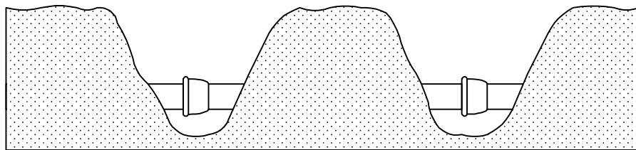
Po izvršenom ispitivanju i poslije završenog geodetskog snimanja za potrebe izrade katastra podzemnih instalacija se vrši zatrpanje spojeva zaštitnim slojem pijeskom uz obavezno nabijanje. Ako projektom nije drugačije predviđeno, debljina zaštitnog sloja iznosi najmanje 10cm.
