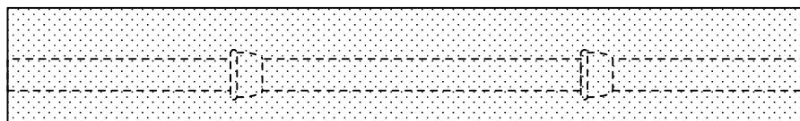
Dalje zatrpanje izvodi se materijalom iz iskopa ili tamponom u slojevima od po 30 cm kao na sledećoj slici. Poslije svakog nanošenja sloja materijala od 30 cm pristupa se nabijanju ispunje rova vibro pločom do predviđene zbijenosti.
