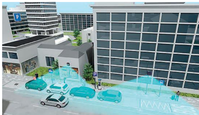
Slika 10. Primjer lokacije senzora na postojećim objektima
