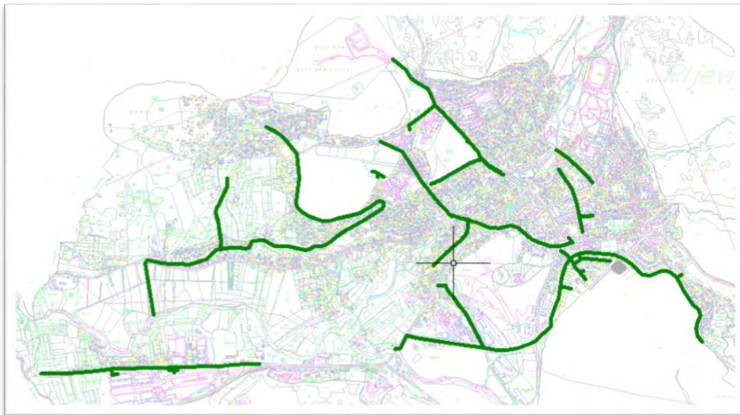
Slika 6.8. Postojeći kolektori atmosferske kanalizacije
