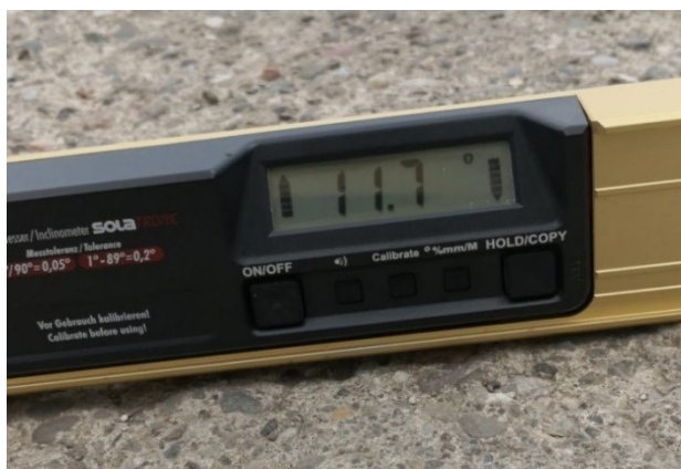
Slika 3.2. Uzdužni nagib rampe za kretanje lica smanjene pokretljivosti i lica sa invaliditetom
