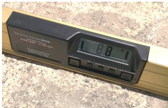
Slika 12.5. Uzdužni nagib rampe za ulazak na perone
