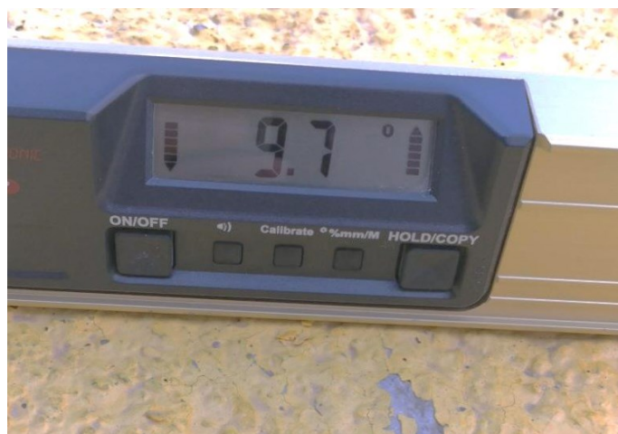
Slika 6.6. Uzdužni nagib prilaza toaletu
