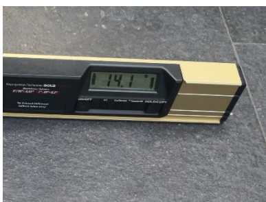
Slika 1.5. Uzdužni nagib na rampi na izlazu sa autobuske stanice
