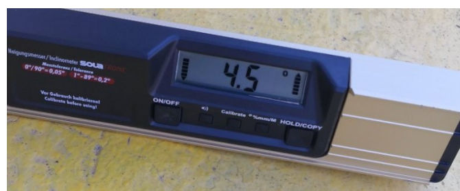
Slika 6.3. Uzdužni nagib prilaza čekaonici
