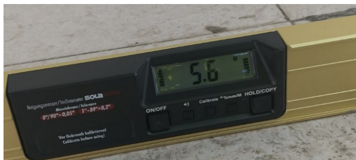
Slika 2.3. Uzdužni nagib rampe na prilazu toaletu za lica smanjene pokretljivosti i lica sa invaliditetom
