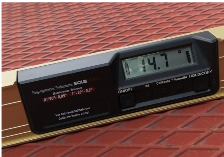
Slika 4.4. Uzdužni nagib prilazne rampe toaletu
