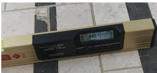
Slika 14.2. Uzdužni nagib rampe za kretanje lica smanjene pokretljivosti i lica sa invaliditetom
