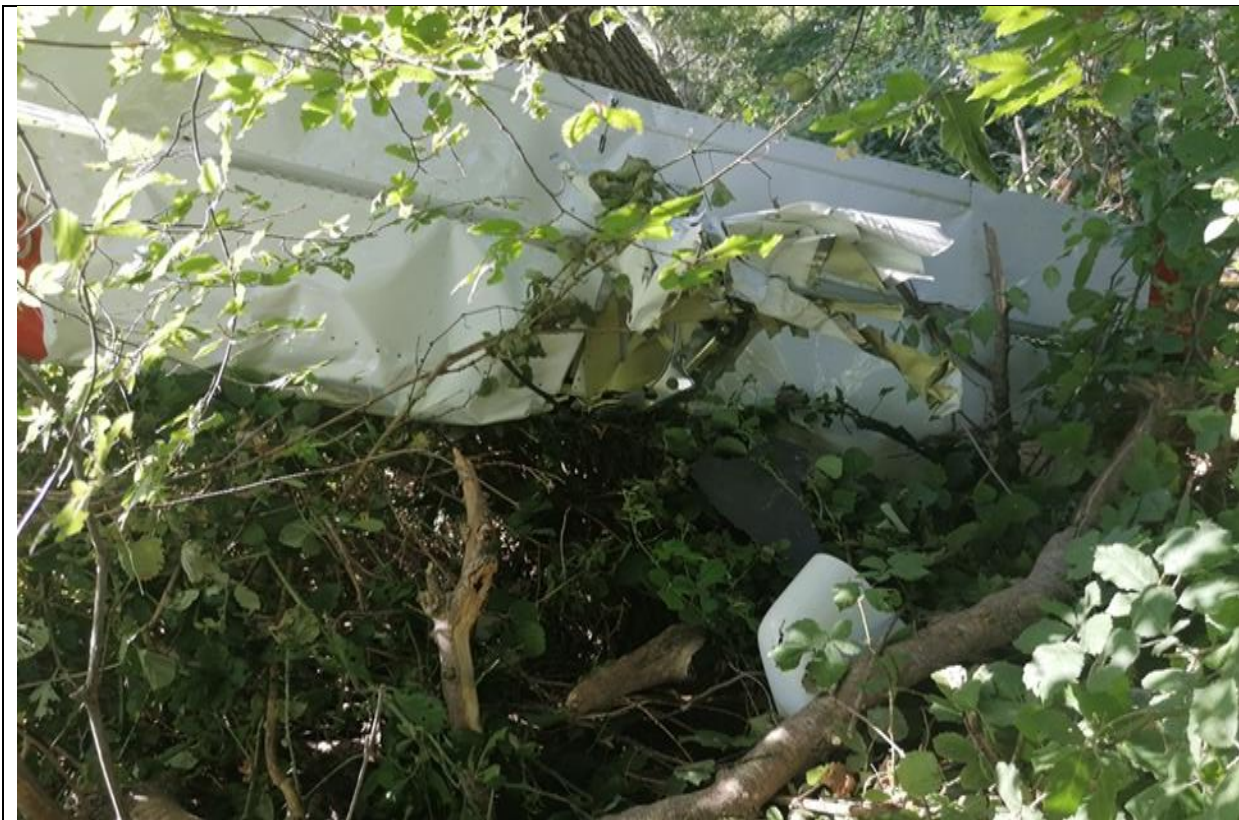
Slika br. 7 - Repne površine otkinute od centralnog dijela oplata aviona
