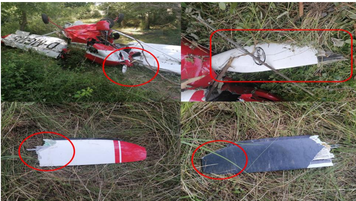
Slika br. 12 – Propeler sa oštećenjima i odlomljenim dijelom lopatice
