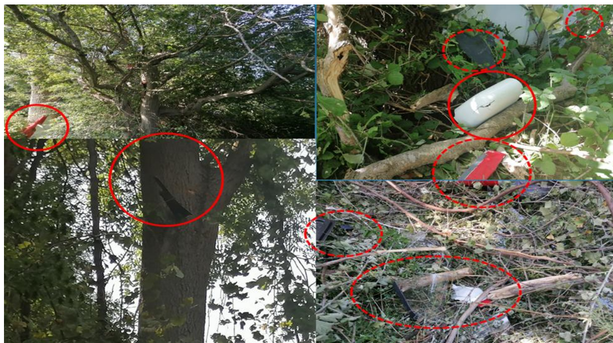
Slika br. 8 - Sitniji djelovi otpali sa konstrukcije aviona
