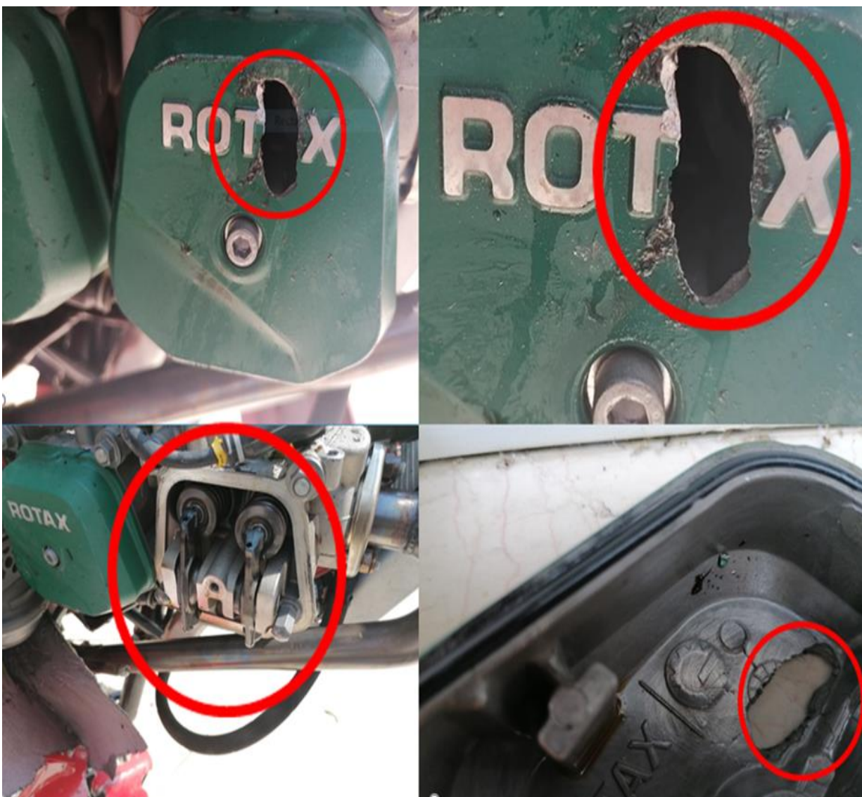
Slika br. 10 - Oštećenja na poklopcu 1. cilindra motora Rotax 912ULC
