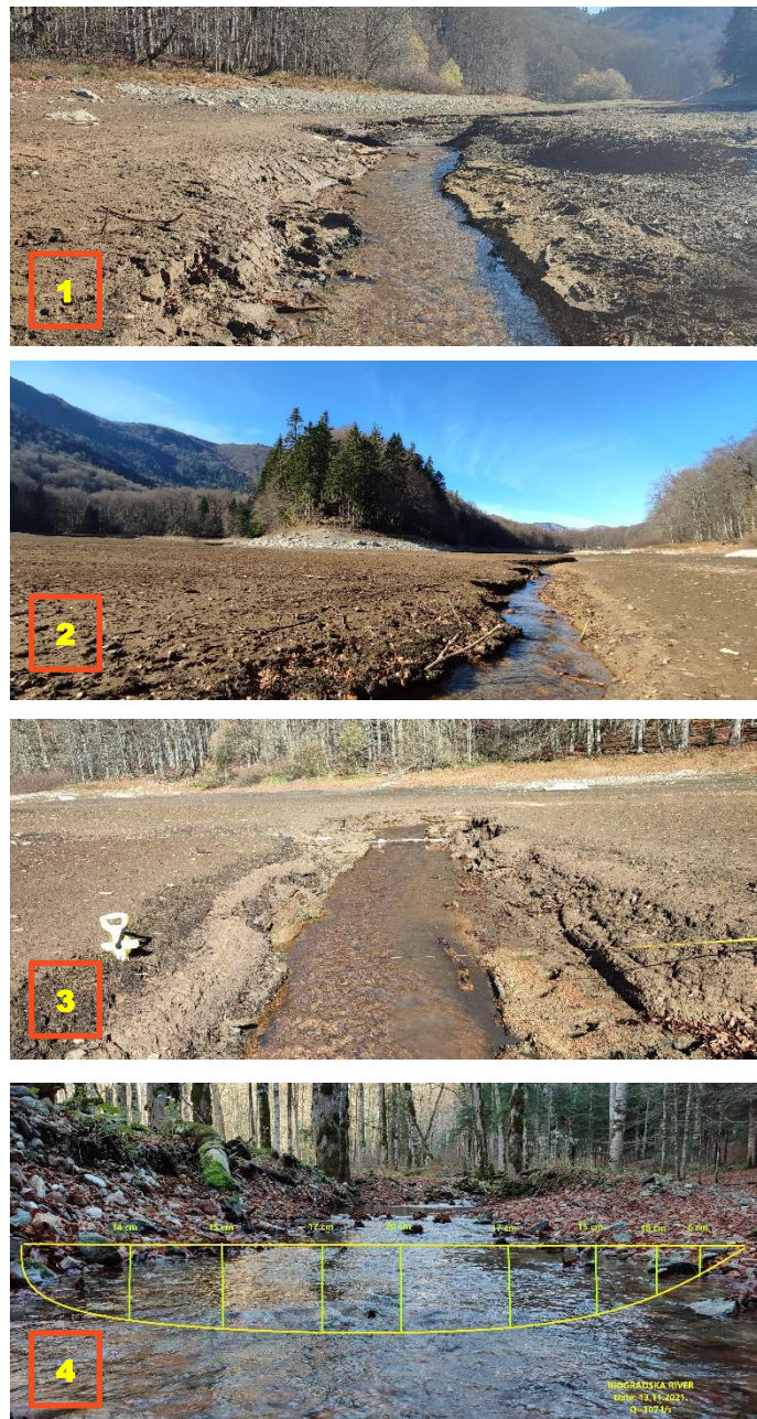
Slika 26. Hidrometrijski profili na Biogradskoj rijeci (Foto: Culafic G., 2021)
